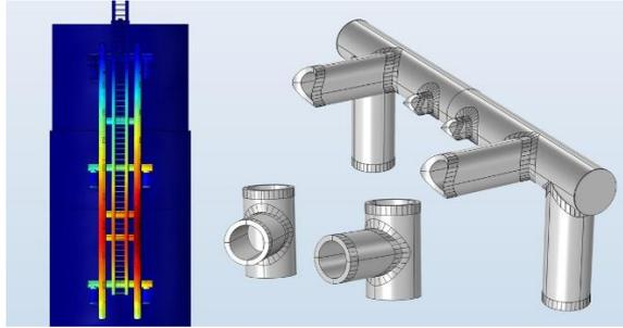
*Les résultats de la simulation permettent de visualiser les champs de contrainte mécanique dans la conception d'un débarcadère (à gauche) et les pièces d'un modèle personnalisé qui peuvent être réutilisées dans différents projets (à droite).*
